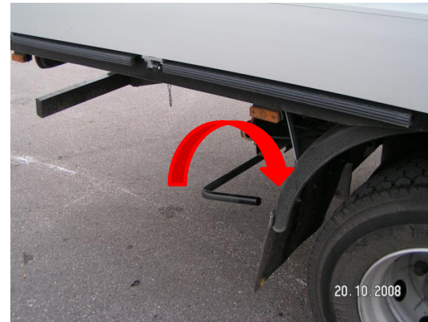
Położenie dźwigni przy uniesionym sworzniu
