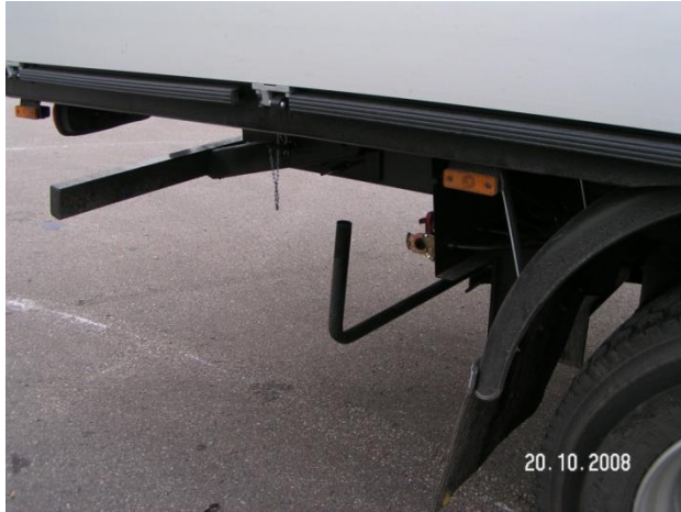
Położenie dźwigni przy opuszczonym sworzniu
