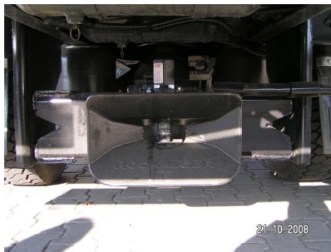
Położenie dźwigni przy opuszczonym sworzniu
