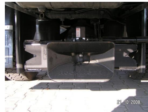
Położenie dźwigni przy uniesionym sworzniu
