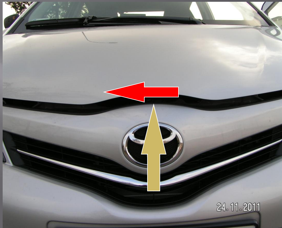
Wsunąć palce, odchylić zaczep w lewo i podnieść pokrywę do góry
