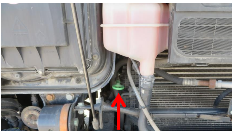
Wskaźnik pomiaru poziomu oleju w silniku
