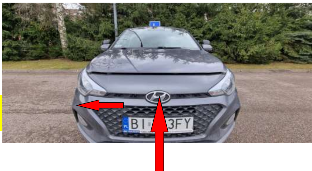
Przy lekko uniesionej masce przesunąć palcem w lewo zaczep blokady i unieść maskę
