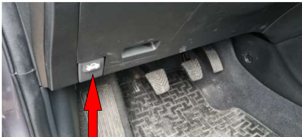
Dźwignia zwalniająca zamek maski
