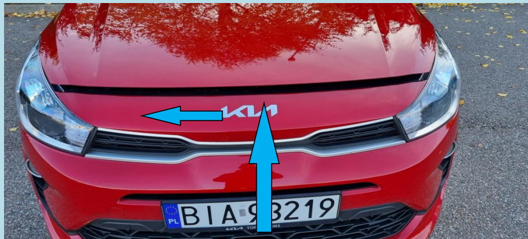
Przy lekko uniesionej masce przesunąć palcem w lewo zaczep blokady i unieść maskę
